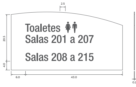
Chapa metálica vistas ortográficas da frente
