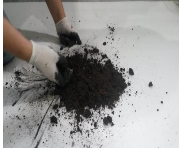
Figura 02 – Lodo sendo destorroado e homogeneizado.
