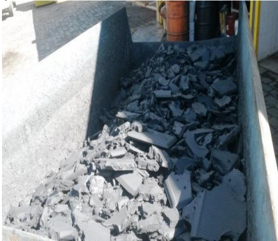
Figura 01 – Lodo resultante do processo de tratamento da empresa sendo encaminhado para o aterro.
